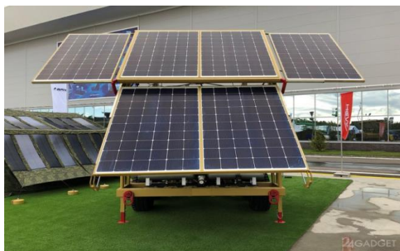
Рис. 3. Автономная, передвижная солнечная электростанция
