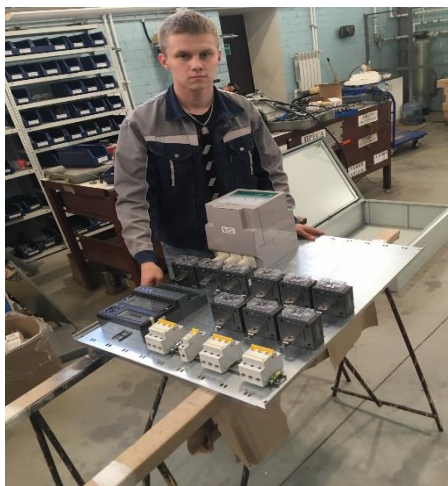
Рис. 1. Этап расстановки оборудования на внутренней панели щита устройства МКС-2-3В в производственном цеху компании «Электросвет», г. Орел, 30 сентября, 2019 г.
