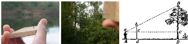
Рис. Измерение высоты дерева с помощью прибора
