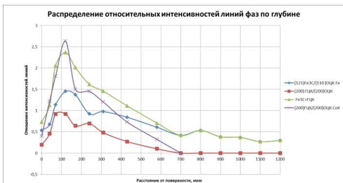
Рис. 2. Результаты послойного РФА закаленного образца со слоем 800 мкм
