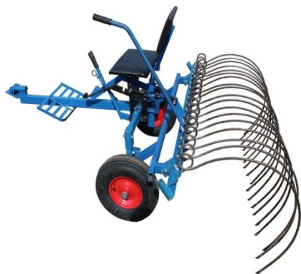
Рис. 1. Грабли для заготовки кормов на малых фермерских животноводческих хозяйствах
