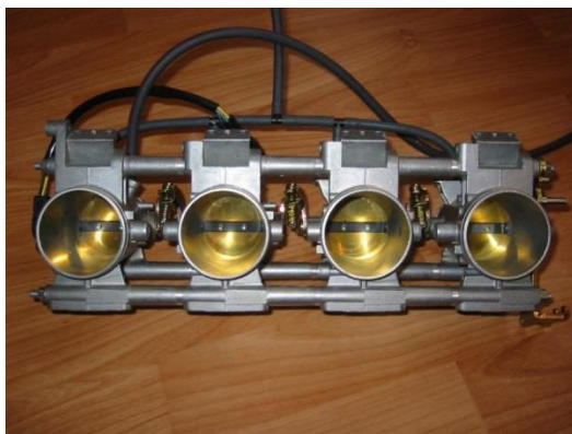
Рис. 1. Многодроссельная система впуска
