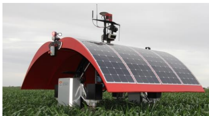
Рис. 1. Робот Ladybird или «Божья коровка»
