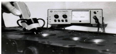
Рис. 2. Общий вид прибора ЭПД-6 с измерительным датчиком и объектом измерения
