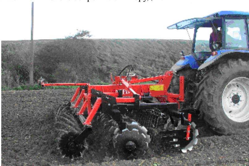
Рис. 1. Комбинированное почвообрабатывающее орудие
