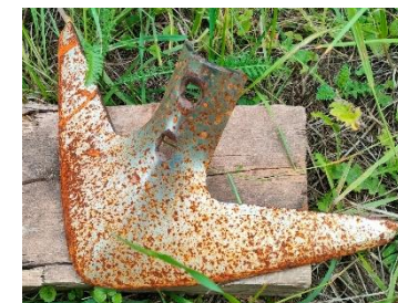
Лапа культиватора (коррозия)
