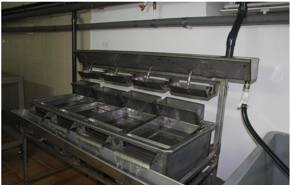
Рисунок 8 – Инкубационный аппарат «Осетр»
