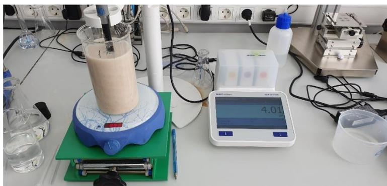
Рисунок 15 - Изменение рН гидролизованной смеси с 6,86 на 4,01 (стакан находится на магнитной мешалке)
