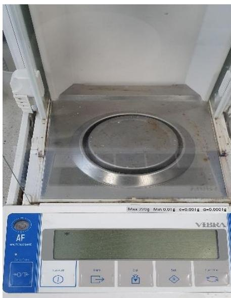
Рисунок 11 - Аналитические весы VIBRA 10 мг, d=0,1 мг
