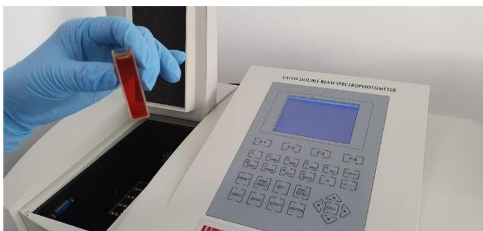
Рисунок 16 - Спектрофотометр и заполненная кювета перед установкой в прибор
