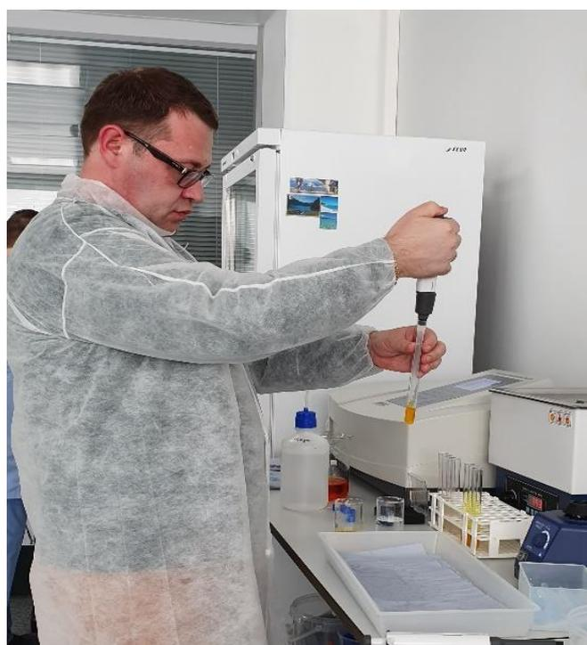
Рисунок 18 - Заполнение пробирок ДНС- реактивом
