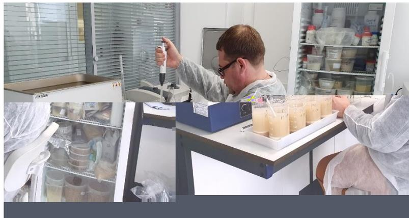
Рисунок 14 - Отбор жидкости после гидролиза в пластиковые пробирки
