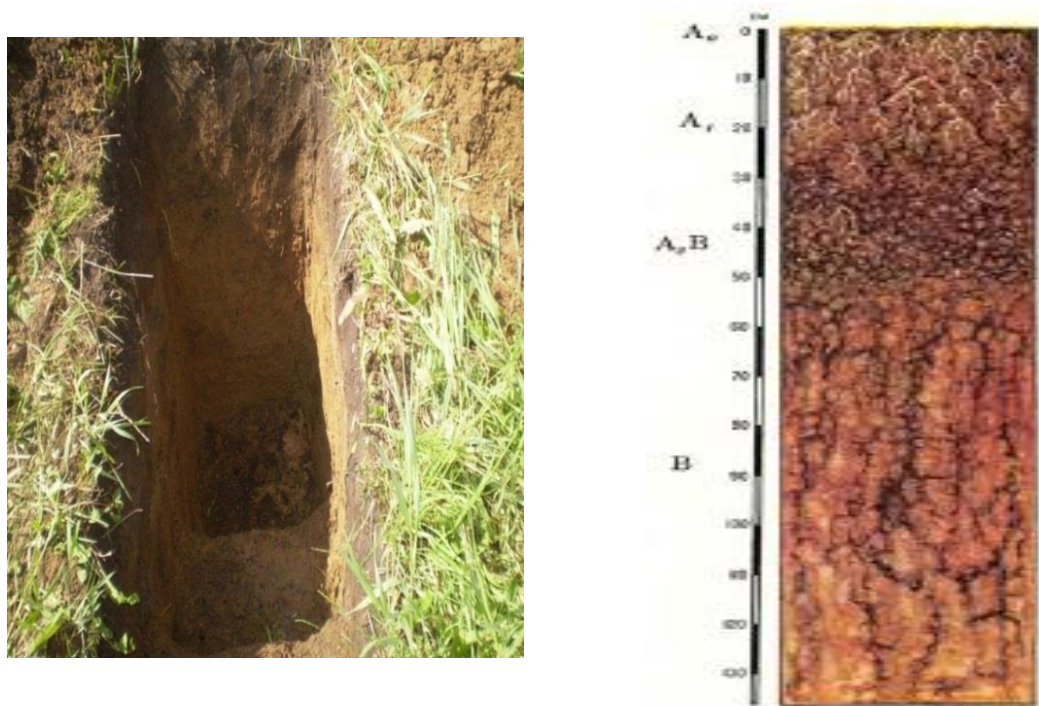
Рисунок 6 – Полнопрофильный разрез и строение профиля почвы на территории опытной агротехнологической станции ФГБОУ ВО РГАТУ
