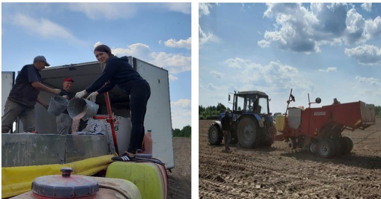
Рисунок 4 - Загрузка сеялки GRIMME GL-430 семенами картофеля и минеральными удобрениями перед посадкой, посадка картофеля
