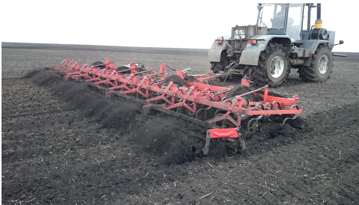
Рисунок 9 – Рыхление почвы перед посевом культиватором ИМТ-616
