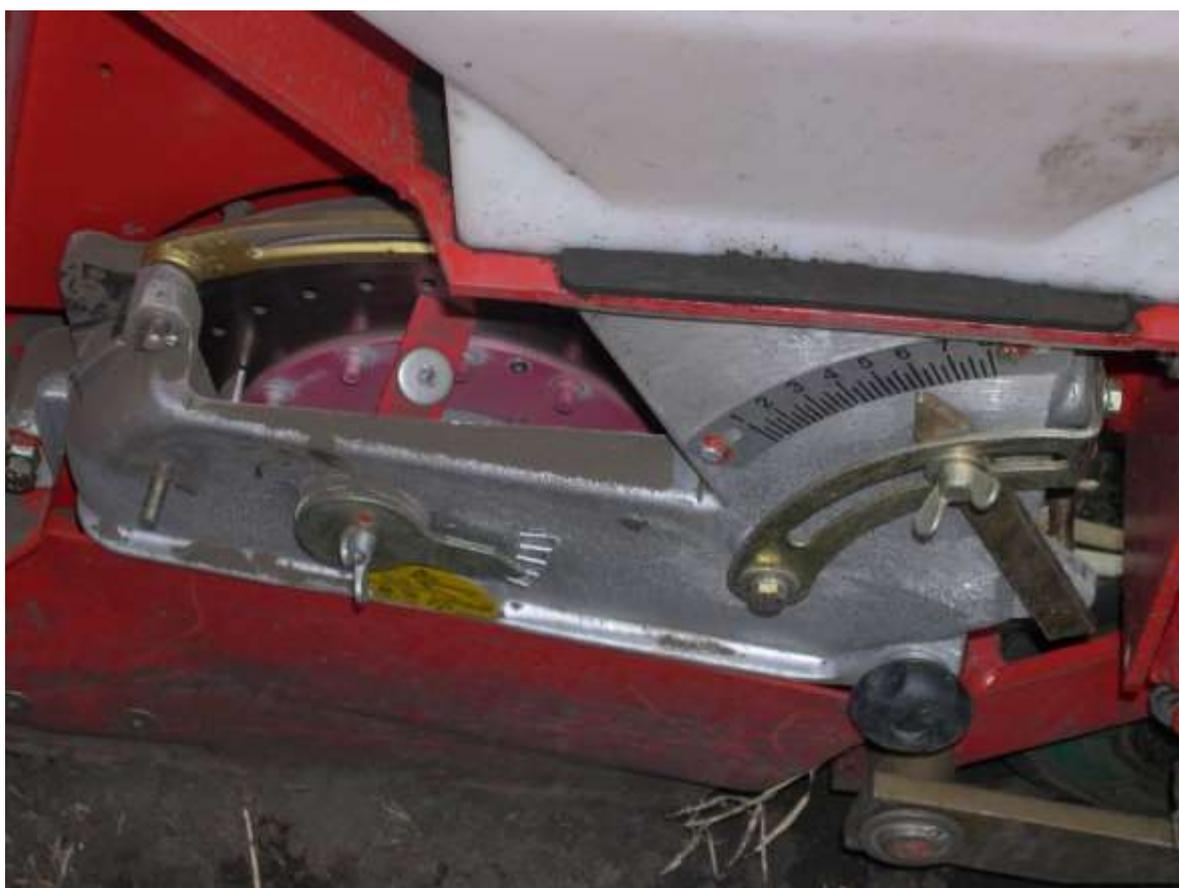
Механизмы регулировки высевающей секции сеялки «Аккорд - Оптима».
