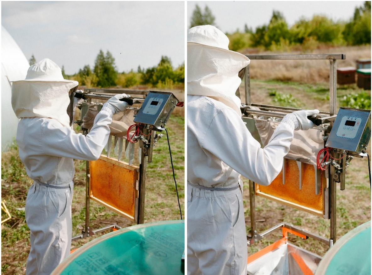
Рис. 44 – Полуавтоматическая распечатка меда на кочевой пасеке
