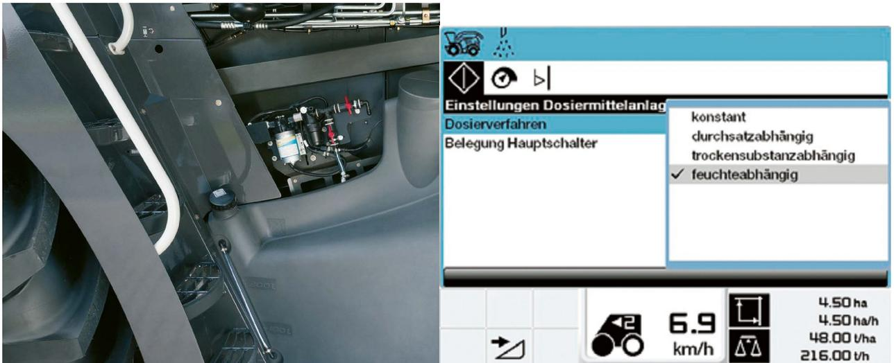
Рисунок 6 – Оборудование для равномерного внесения консерванта в силосуемую массу
